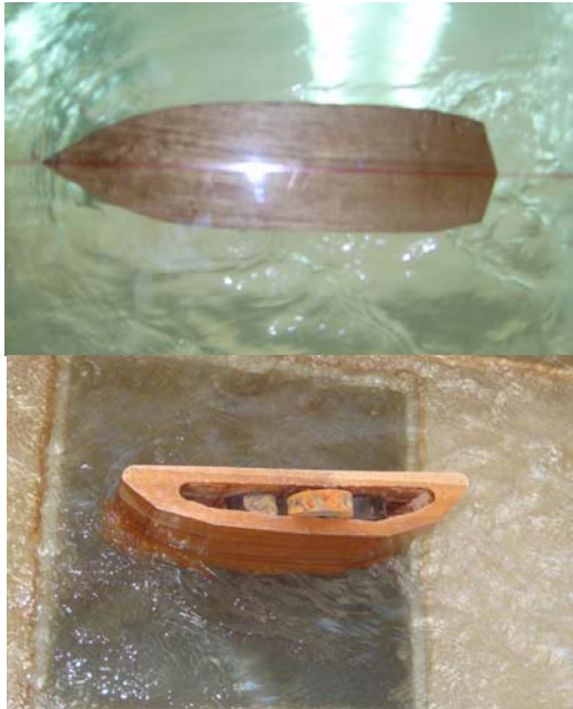
Figura 7.- Flujos alrededor de Plano de flotación (vista inferior) y Sección Segmentada (vista superior)
