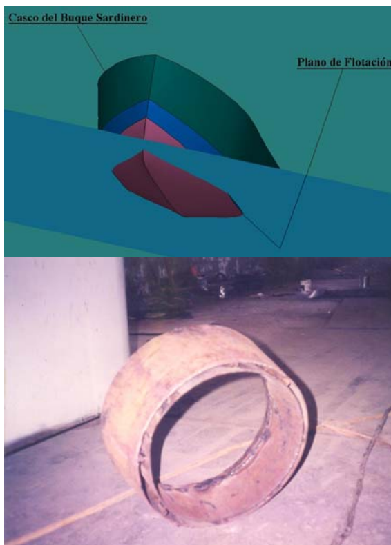
Figura 1.- Plano de flotación de un buque y Tobera de construcción local formada con segmentos
