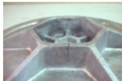
Figura 8. Tapa ensayada hasta la ruptura
