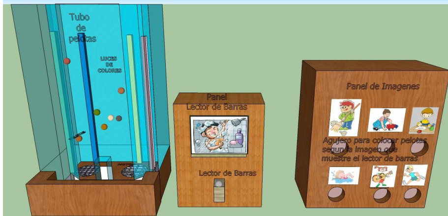
Fig. 4. Módulo “Tubo de pelotas interactivo multietapa” que posee 3 componentes interactivos: un tubo que selecciona de manera aleatoria una pelota con un código de barras, un lector que visualizará el contenido del ejercicio o pregunta y un panel donde se deberá colocar la pelota.
