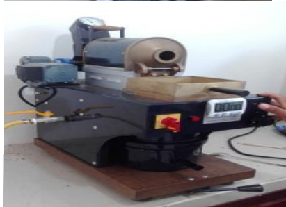
Tostadora con una temperatura de 140 grados
